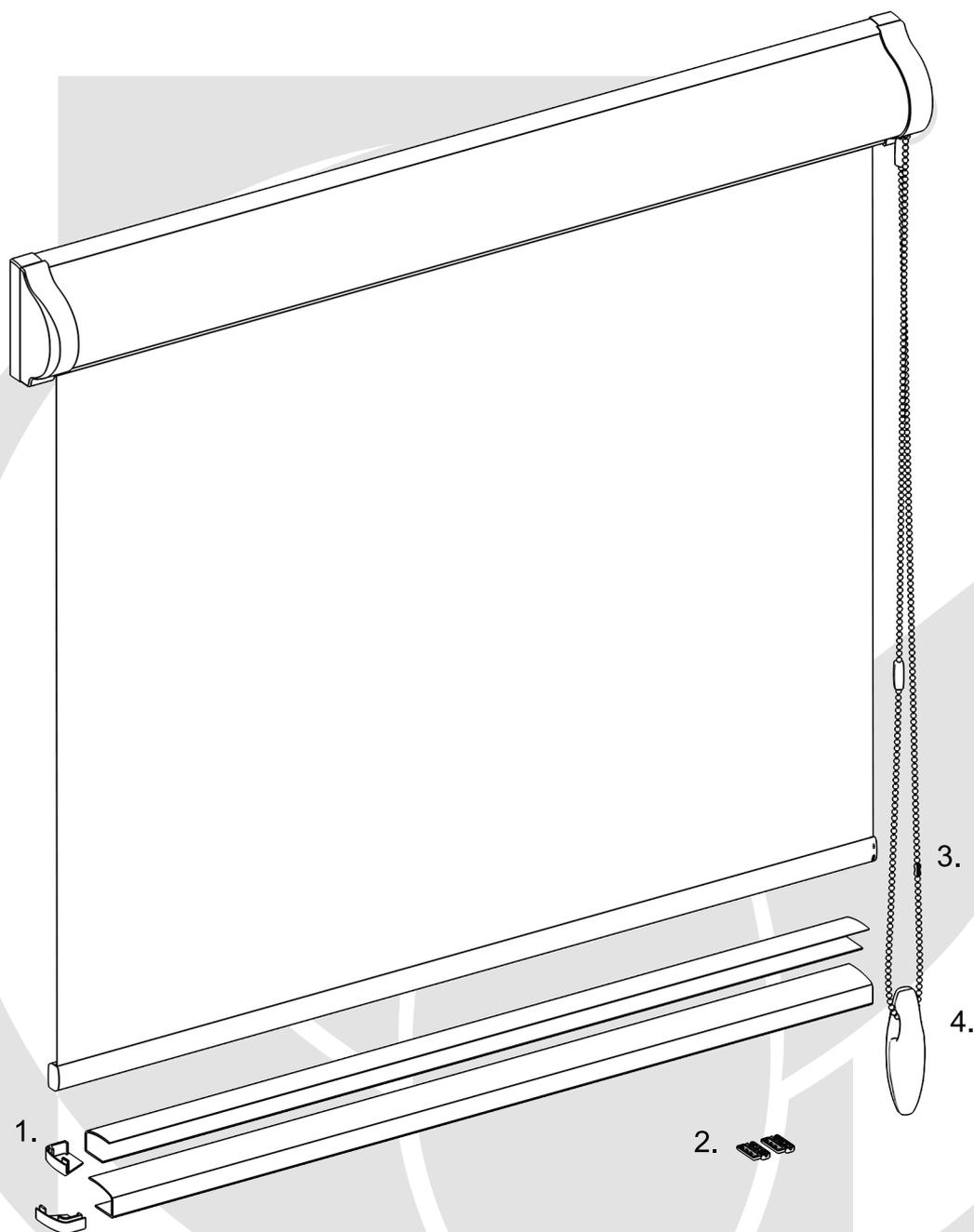
1. Führungsschiene mit Stöpsel.
