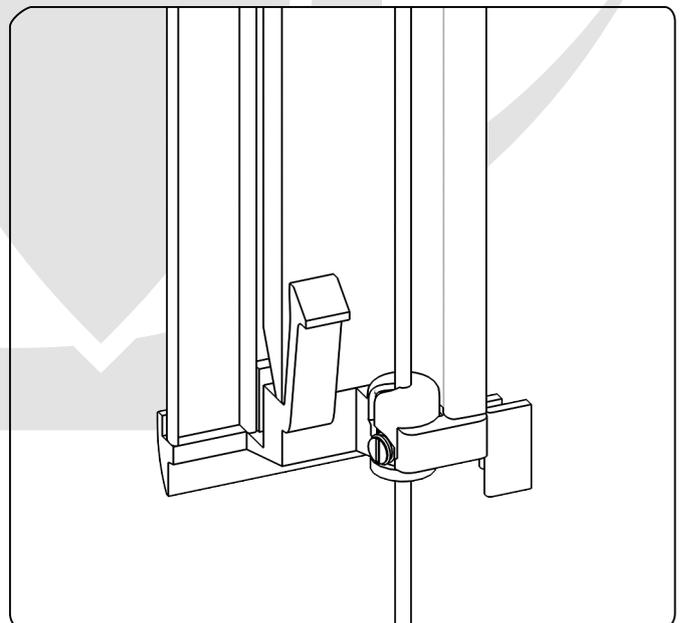
Platzierung der unteren Schiene in der Führungleiste.
