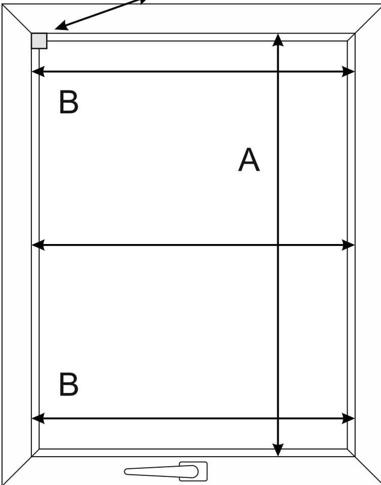
Bei Aufgabe einer Bestellung sind der Hersteller und das Symbol des Fensters anzugeben. Die Entfernung ist zwischen den Brechkanten des Rahmens zu messen. Wenn es sich um die Breite handelt, muss die Messung an 3 Stellen durchgeführt werden. Als richtig wird der geringste Wert angenommen.
