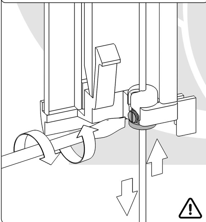
Wenn der Rolladen heruntergelassen ist und dabei Falten entstehen, ergibt sich dies aus einer ungleichmäßigen Spannung der Schnüre. In diesem Fall ist die Spannung einzustellen.
