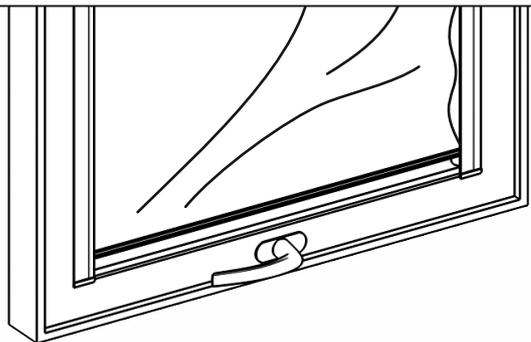
Nach der Montage des Produktes, die Seitenschnur einstellen, so das die Feder gut gespannt ist. Damit das Rollo bei jeder Position die Sie einstellen stehen bleibt.
