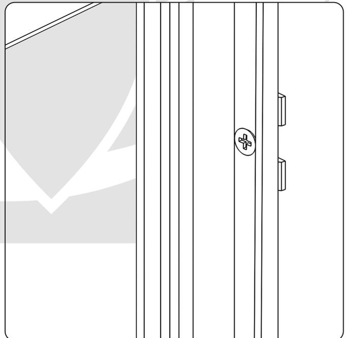
Nach Beendigung der Montage ist der Rollladen probenweise herunterzulassen. Im Falle eines Widerstands darf man die Schnur auf keinen Fall gewaltsam ziehen! Es ist zu prüfen, auf welcher Seite der Widerstand entsteht und dort zusätzliche Unterlegscheiben unter Führungen zu montieren. Danach soll man sich vergewissern, ob die Führungen zueinander senkrecht liegen und die Entfernungen dazwischen auf deren ganzen Höhe gleich sind.
