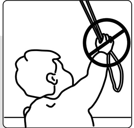
Um die Gefahr des Erstickens auszuschließen, wird das Schienensystem mit einem Schnurhalter ausgestattet. Durch die Normen: **EN 13120:2009 + A1:2014.**
