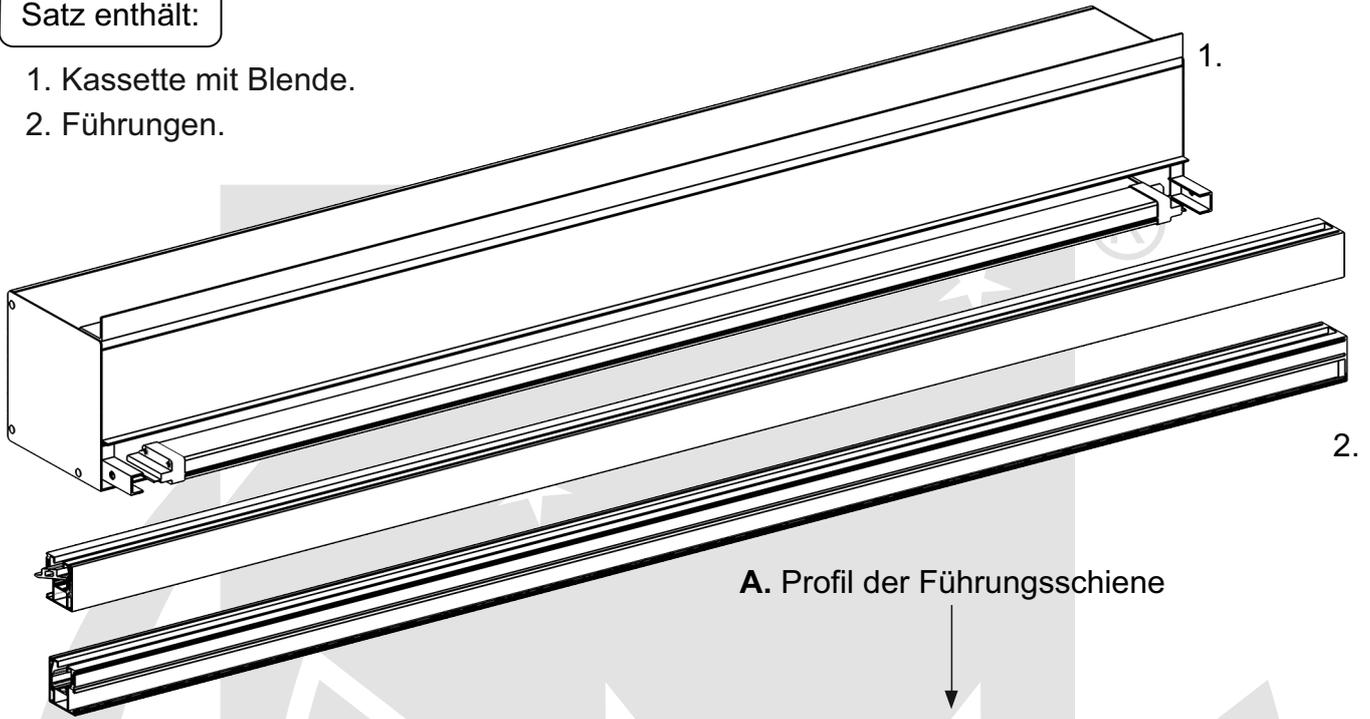
Aufbau einer 3-teiligen Führungsschiene in ein ZIP-System:
