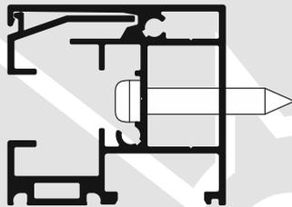
**Aufmerksamkeit!** Beim Verschrauben der Führungen ist unbedingt darauf zu achten (**notwendig!**), dass die Führungen vertikal parallel zueinander verschraubt werden, die Kassette waagrecht steht und die Diagonalen zwischen den Führungen gleich sind.
