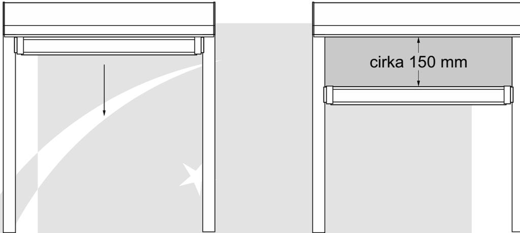
Nach dem Absenken und Einschub des Materials in den ZIP-Führungseinsatz, platzieren Sie den Einsatz in der Führung.
