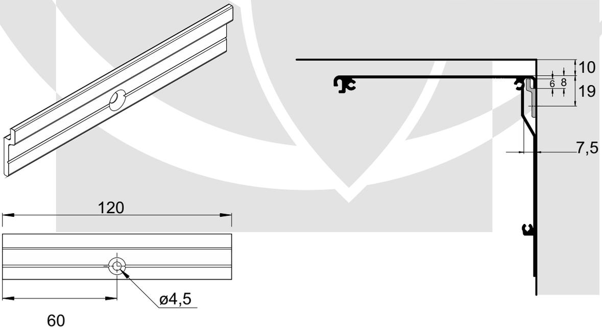
Montage des SCREEN-Rollos (vergiss nicht das Versorgungskabel anschließen!).
