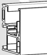
B. Revisionsprofil der Führungsschiene
