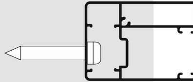
**Aufmerksamkeit!** Beim Verschrauben der Führungen ist unbedingt darauf zu achten (**notwendig!**), dass die Führungen vertikal parallel zueinander verschraubt werden, die Kassette waagrecht steht und die Diagonalen zwischen den Führungen gleich sind.
