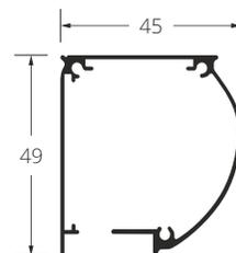
Rys.2 Standard Führungsleiste.
